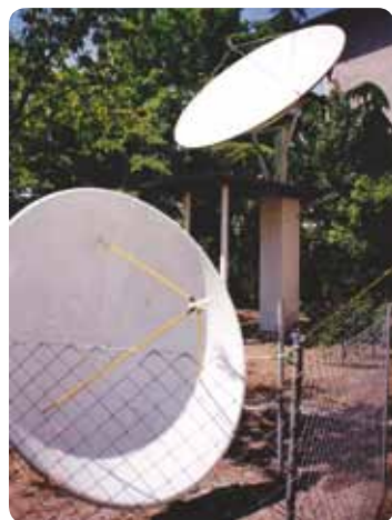
■ 放置在前面的1.5米的小碟形天线被Cahit用来接收位于东经28.2度的ASTRA 2卫星
