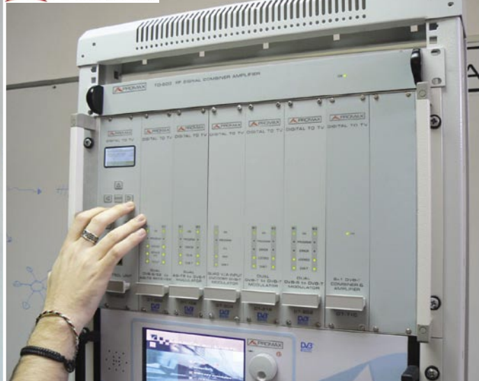
■ 通过实际连接，理论得以验证：每个孔代表一个信号源。在另一端，DVB-T 上可获得一组混合信号。
