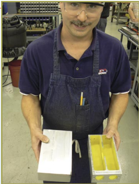
■ 戴尔·牛顿向我们展示生产的顺序：从铝块(左边)到一个铣出接口和螺孔的完整滤清器壳体(右边)。
