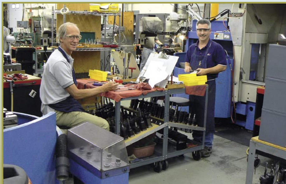
在数控铣床旁边的是布鲁斯·森托夫（左边）和戴尔·牛顿（右边），许多滤波器的壳体就是在这里生产出来的。“在头天通宵进行自动加工后，我们就在晚上编程”，布鲁斯·森托夫解释说。
