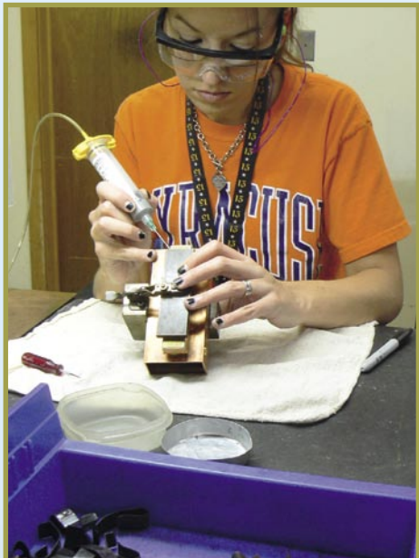
■ 这里，在机械装配一个滤清器。MFC 的员工梅莉莎·本茨在为焊炉准备一个滤清器...
