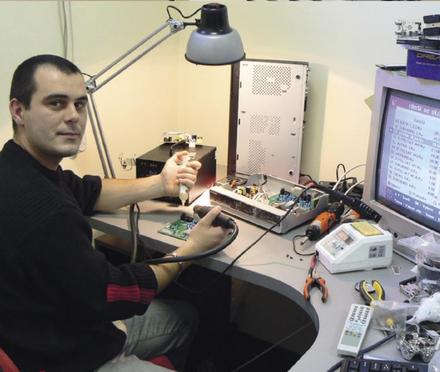
■ 即使质量再好的产品也可能有瑕疵。彼得·希尔加克是 ABC BIZNIS 公司的两名技术员之一。他正在这里更换电路板上的一个芯片。
