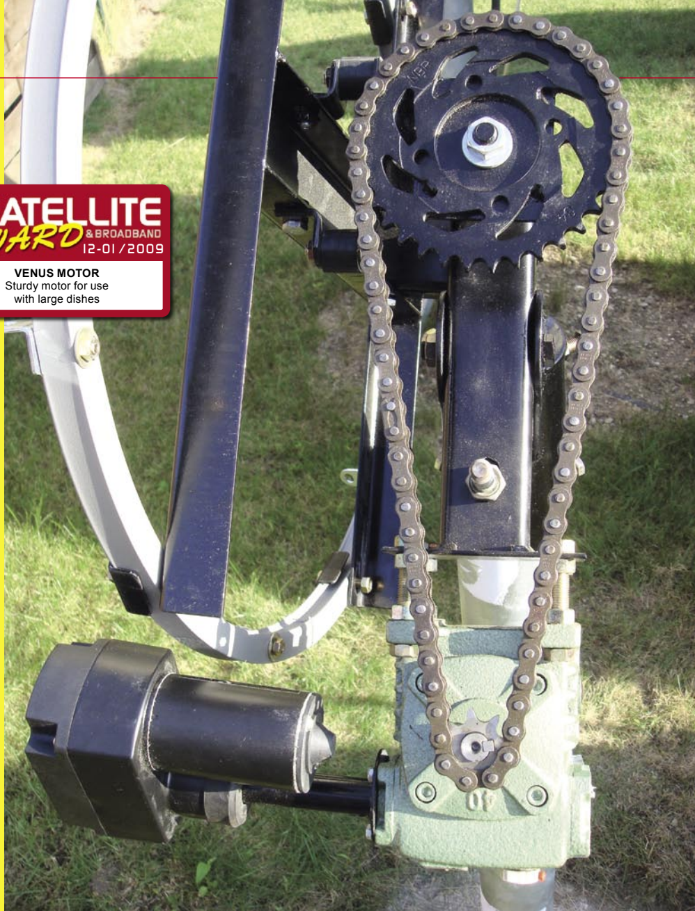
■ PT. Subur Semesta 公司生产的马达。它用链条将马达齿轮和天线极轴连起来。
