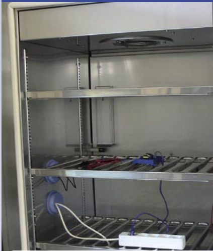
■ 完工的复合开关也要放在这间环境仓里进行测试。按规定此设备的温度为 -20^{\circ}\text{C} 到 +50^{\circ}\text{C} ，弗里德里希·斯堡解释说，“为了确保产品质量，我们就设置成 -30^{\circ}\text{C} 到 +60^{\circ}\text{C} ”。
