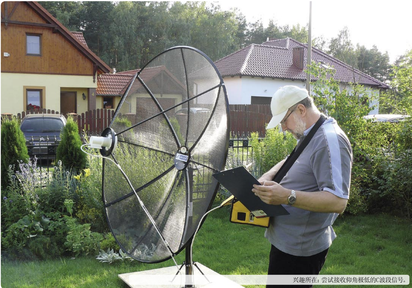
测试和调整天线。我们用一个水平尺来测定仰角，通常会很接近正确值。
