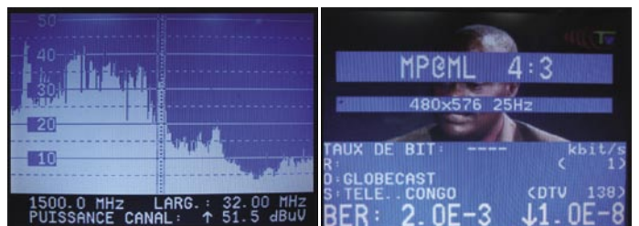
338E° (22W°)上NSS7卫星 NSS7卫星的一个频道信号的频谱
