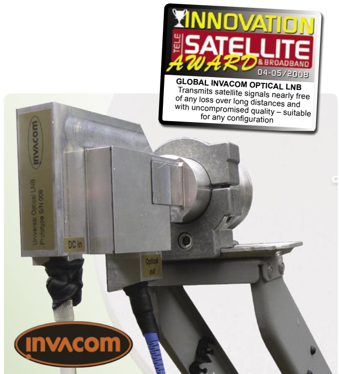
环球 Invacom 公司的光缆 LNB: 10 个手工制作的全能原型中的第 9 个。
