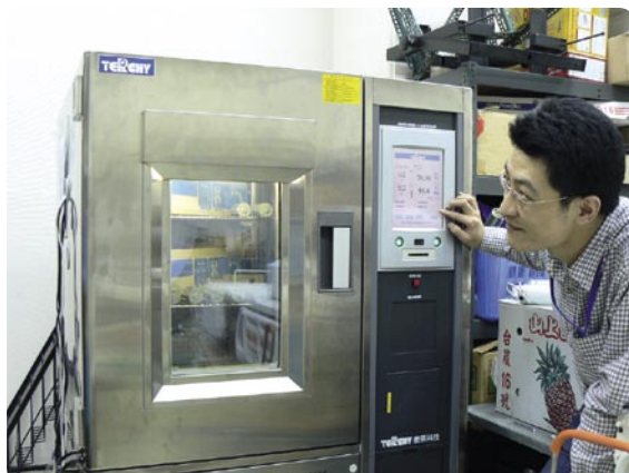
从生产线取来样本,放在热/冷环境室里进行测试,并被加热到70 °C。测试的温度为-40 °C到 +90 °C。
