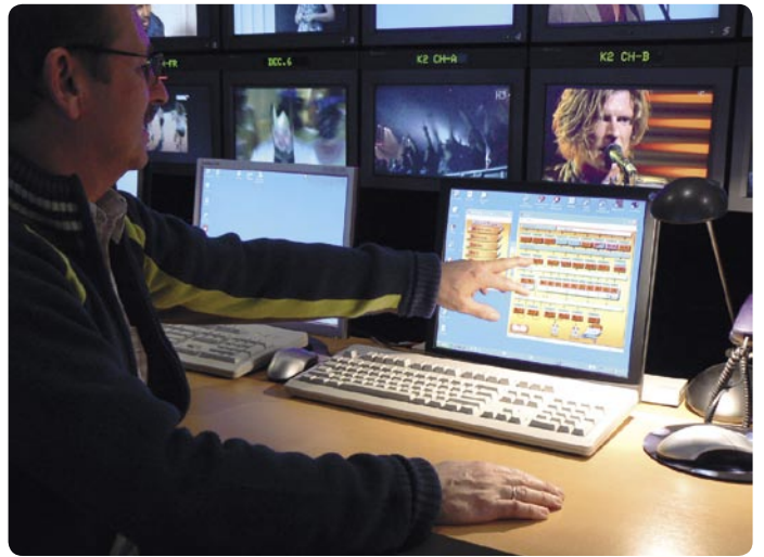
▲技术总监雅克·舍泼斯在电视控制台前演示：信号被发送给Astra卫星上的两个转发器，通过鼠标器的点击就可以决定到Eutelsat卫星上还是进入有线网。
